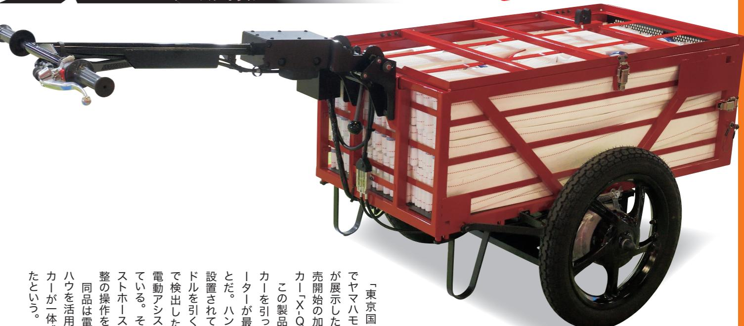
「東京国際消防防災展2023」でヤマハモーターエンジニアリングが展示したのは、令和6年4月に販売開始の加納式電動アシストホースカー「X-QUICKER」だ。この製品の最大の特徴は、ホースカーを引っ張る状況に合わせて、モーターが最適なアシストを行えることだ。ハンドルの根元にセンサーが設置されており、このセンサーがハンドルを引く力を検出する。センサーで検出した荷重と速度を総合して電動アシストする力を自動で決定している。そのため、従来の電動アシストホースカーで必要だった速度調整の操作を不要とした。
