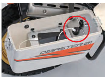
シガーソケット ※シガーソケットと端末を接続するプラグは別途ご用意ください。
