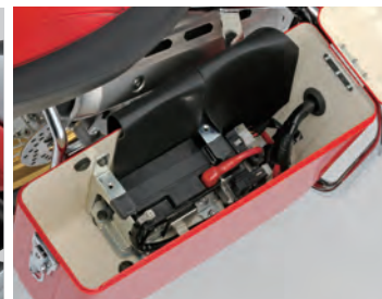
バックアップ電源装置
